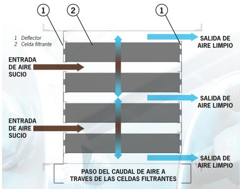
Imagen ilustrativa de flujo de aire a través de una unidad de paso único Las celdas están dispuestas de manera que el aire fluye horizontalmente a través de la unidad, obligándolo a cambiar de dirección para pasar verticalmente por las celdas a través de un sistema de deflectores. Estos deflectores aseguran que el aire no pueda evitar su paso por las celdas, lo que proporciona una unidad altamente eficiente.
